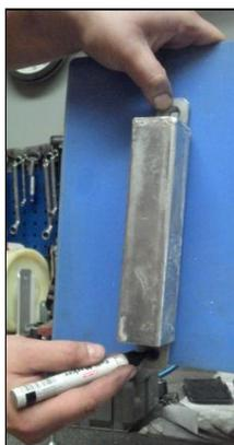
5. Die untere Bohrung ebenfalls am Tor markieren.
