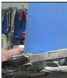
8. Das Rollenoberteil nun zur Seite drehen und das Unterteil mit Feder + Rad wieder in das Oberteil einschieben. Die 17er Mutter oben wieder befestigen.
