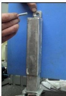
9. Nachdem die Torstützrolle wieder zusammen gebaut ist, kann man die obere Befestigung nun auch mit einer Senkkopfschraube am Tor befestigen.
