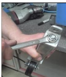
3. Die 17er Mutter oben auf der Rolle mit einem 17er Ring- oder Gabelschlüssel entfernen.
