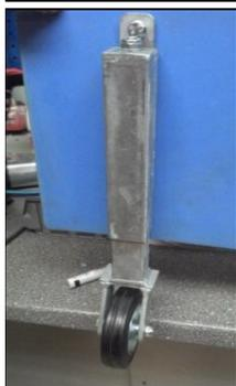
10. Wenn alles fest verschraubt ist und die Rolle in Höhe + Vorspannung am Tor korrekt eingestellt wurde, ist die Torstützrolle funktionsbereit.
